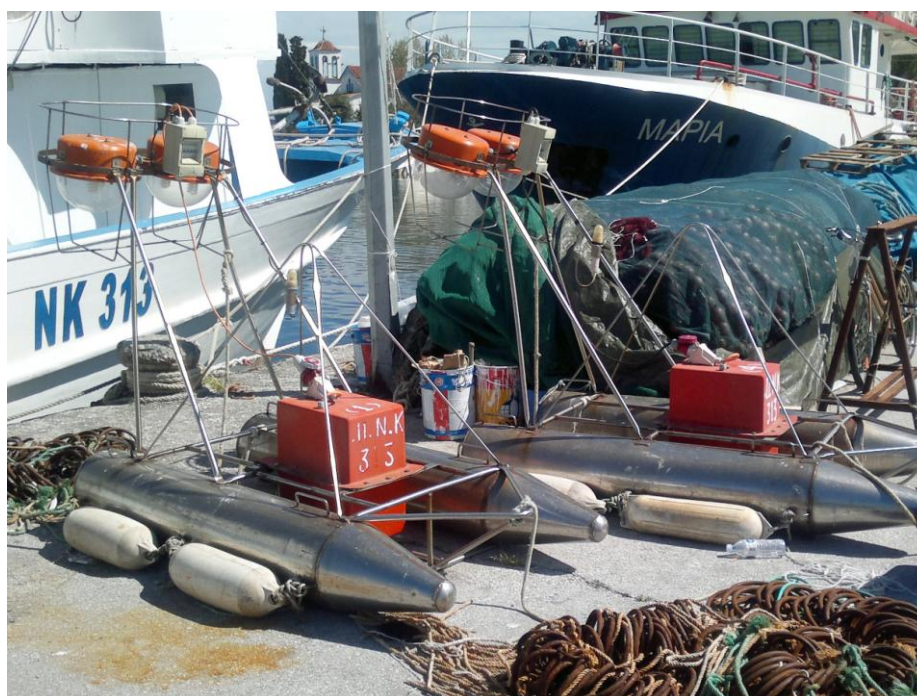
Εικόνα 3.3.2/1: Εικόνα μέρους του αλιευτικού εξοπλισμού που είχε τοποθετηθεί εκτός του σκάφους κατά τις εργασίες συντήρησής του. Σε πρώτο πλάνο φαίνονται δύο από τους πλωτούς ηλεκτρικούς φανούς (ρομπότ) που χρησιμοποιούνταν κατά την αλιεία.
