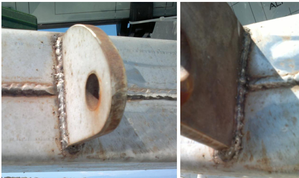
Εικόνες 4.2/6 & 7: Εικόνες της συγκόλλησης του ωτίου για τη συγκράτηση του συρματόσχοινου ασφαλείας.
