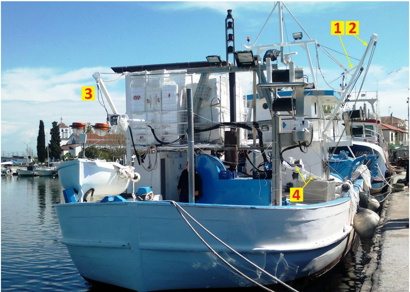
Εικόνα 4.1/1: Εικόνα από το σκάφος, στην οποία διακρίνονται τα 04 ανυψωτικά μέσα αυτού:
